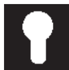
Profilzylinderschloss (PZ) Sicherung durch verschiedene Schlüsselprofile mit unterschiedli- chen Einschnitten bzw. Vertiefun- gen / Schloss für den Einbau von Profilzylindern vorgerichtet Schloss für 2-tourige Schließung Mit Sicherheitsanforderung
